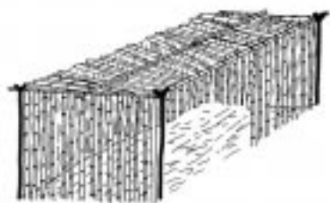
FIGURA 18. VIVERO CONSTRUIDO CON CAÑA O BAMBÚ
