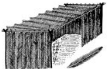
FIGURA 19. VIVERO CONSTRUIDO CON HOJAS DE PALMA
